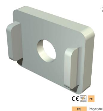
Zur Vergrößerung der Klemmhöhe bei Kabelklammern von 9 auf 13 mm bei dickeren Leitungen, schlagfestes Polystyrol.
