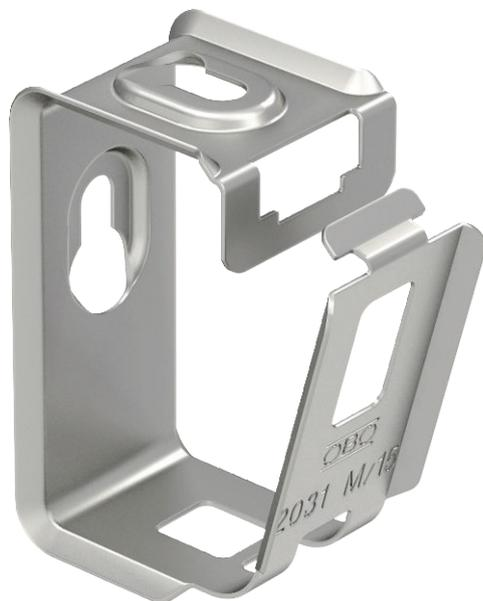
Sammelhalter aus Metall für hohe mechanische Standfestigkeit, auch im Brandfall. Zur sicheren Montage oberhalb von Brandschutzdecken geeignet. Auch als kabelspezifische Variante für den elektrischen Funktionserhalt nach DIN 4102 Teil 12 zugelassen. Für Wand- und Deckenmontage. Verschluss ohne Werkzeuge zu öffnen. Detaillierte Informationen der zugelassenen Verlegevarianten sind den entsprechenden Prüfdokumenten zu entnehmen.
