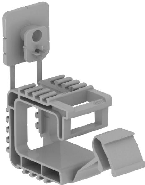
Sammelhalterung für die allgemeine Anwendung mit Befestigungslöchern 6 mm Ø, geeignet für Wand- und Deckenmontage. Das angespritzte Befestigungselement kann mit Schlagdübel oder Gasdrucknagelgerät befestigt werden. Steingraue Ausführung, flammwidrig nach DIN VDE 0471/DIN IEC 695 Teil 2-1, Prüftemperatur 960°C. Der empfohlene Befestigungsabstand bei voller Belegung beträgt 50-60 cm.
