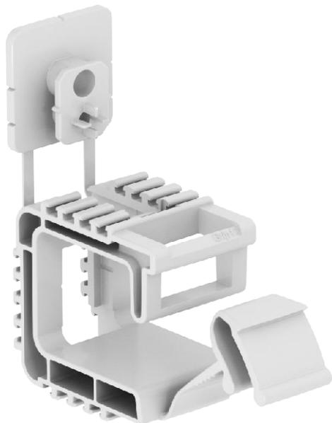
Sammelhalterung für die allgemeine Anwendung mit Befestigungslöchern 6 mm Ø, geeignet für Wand- und Deckenmontage. Das angespritzte Befestigungselement kann mit Schlagdübel oder Gasdrucknagelgerät befestigt werden. Der empfohlene Befestigungsabstand bei voller Belegung beträgt 50-60 cm.
