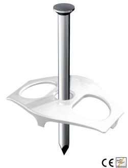
Mit vormontiertem, verzinkten Stahlnagel Ø 3 mm oder 3,5 mm zur Fixierung von Leitungen in Mauerschlitzen und auf Mauerwerk für 1 bzw. 2 Leitungen NYM 3 x 1,5/2,5 mm² oder 1 bzw. 2 Leitungen NYM 5 x 1,5/2,5 mm².
