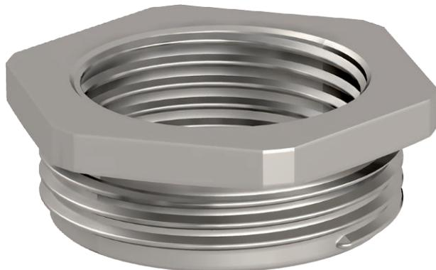
Adapter zum Reduzieren von einer metrischen Gewindebohrung auf eine kleinere Pg-Gewindebohrung.
