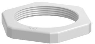
Gegenmutter nach DIN 46320, mit PG-Gewinde nach DIN 40430. Hinweis: Gegenmuttern aus Polystyrol wegen der Gefahr der Spannungsrissbildung nur mäßig anziehen!
