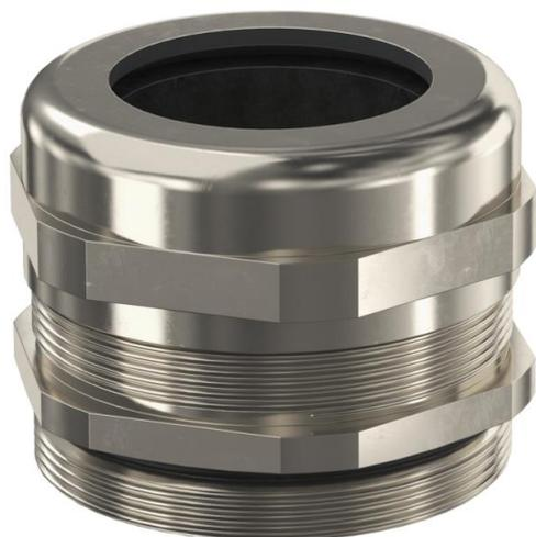
Robuste Kabelverschraubung mit metrischem Anschlussgewinde nach IEC 423 in Hutmutterbauart für hohe Dichtigkeitsansprüche. Zugentlastung, Verdreh-schutz und Dichtigkeit über den gesamten Spannbereich. Dichtring aus Neopren. Klemmeinsatz aus Polyamid. Mit vormontiertem Dichtring am Anschlussgewinde, VDE-geprüft nach DIN EN 50262, Schutzart IP68 bei 5 bar/1h, Temperaturein-satzbereich -20 bis +100°C.
