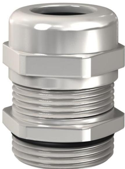
Robuste EMV Kabelverschraubung mit metrischem Anschlussgewinde nach IEC 423 in Hutmutterbauart für hohe Dichtigkeitsansprüche. Zugentlastung, Verdreh- und Dichtigkeit über den gesamten Spannungsbereich. Dichtring aus Neopren. Klemmeinsatz aus Polyamid. Mit vormontiertem O-Dichtring am Anschlussgewinde, VDE-geprüft nach DIN EN 50262, Schutzart IP68 bei 5 bar/1 h. \* Preise laut DEL-Notierung.
