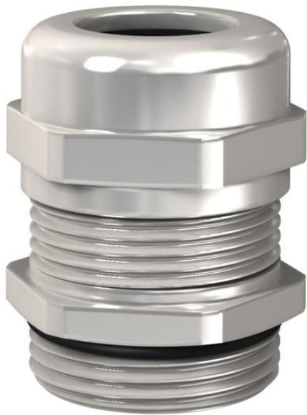
Robuste EMV Kabelverschraubung mit metrischem Anschlussgewinde nach IEC 423 in Hutmutterbauart für hohe Dichtigkeitsansprüche. Zugentlastung, Verdreh-schutz und Dichtigkeit über den gesamten Spannungsbereich. Dichtring aus Neopren. Klemmeinsatz aus Polyamid. Mit vormontiertem O-Dichtring am Anschlussgewinde, VDE-geprüft nach DIN EN 50262, Schutzart IP68 bei 5 bar/1 h. \* Preise laut DEL-Notierung.
