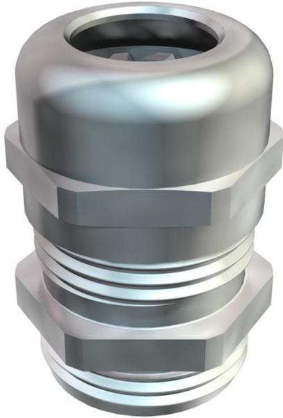
Kabelverschraubung in Hutmutterbauart mit großem Dichtbereich sowie Zugentlastung und Verdrehenschutz für hohe Dichtigkeitsansprüche, mit PG-Anschlussgewinde nach DIN 40430. Klemmeinsatz aus Polyamid, Dichtring aus Chloropren-Nitrilkautschuk, mit vormontiertem O-Ring am Anschlussgewinde. Schutzart IP68 bei 5 bar/1 h, geprüft nach VDE 0619. Anschlussgewindelänge „normal“, in Anlehnung an DIN 46320.
