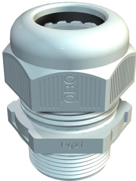
Kabelverschraubung mit PG-Anschlussgewinde in Hutmutterbauart, für Kabelabzweiggästen, Gehäuse, Verteilerkästen im privaten und industriellen Bereich. Mit Zugentlastung und integrierter Dichtlippe, geprüft nach DIN EN 62444. Schutzklasse IP68. Einsetzbar von -20°C bis +65°C.
