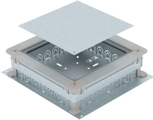
Unterflur Zug- und Abzweigdose für je 7 Installationsrohre pro Seite (M20 oder M32) mit Seitenwänden aus Stahlblech. Zur Montage von Einbaueinheiten in Montagegedeckel (separat zu bestellen). Lässt sich stufenlos auf Estrichnennhöhe nivellieren (Schnellnivellierung möglich) und der Estrich kann bündig an die Estrichabzugskante angearbeitet werden. Mit schalltechnischer Entkopplungsmöglichkeit nach Estrichverlegung und mit Systemzubehör auch für Schwerlastanwendung verwendbar.
