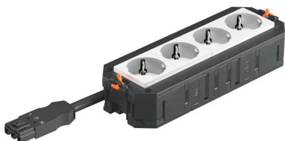
Der anschlussfertige Universalträger UTC4 verfügt über 4 vorinstallierte 33°-Schutzkontaktsteckdosen in weiß, 250 V~ 16 A. Passend zu den Verbindungsleitungen VL und den Geräteeinbaueinheiten der Nenngröße R7, R9 und 9.
