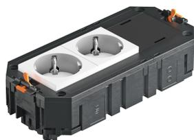
Der anschlussfertige Universalträger UTC3 verfügt über zwei vorinstallierte 33° Schutzkontakt-Steckdose und eine Blindabdeckung für den nachträglichen Einbau von einem Installationsgerät der Serie Modul 45 oder Modul 45connect. Passend zu den Verbindungsleitungen VL und den Geräteeinbaueinheiten der Nenngröße 2, 4, R4, 6 und R7.
