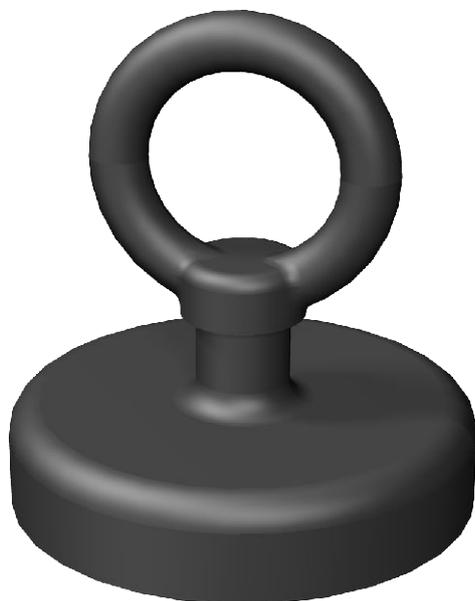
Magnetheber WZ 1028 für das Herausheben von Dosen- und Kanaldeckeln mit überklebten textilen Bodenbelägen mit einer Dicke von 3-10 mm. Haftkraft: 1.300 N
