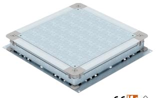
Unterflur Zug- und Abzweigdose für estrichüberdeckte Unterflur-Installationskanäle mit Seitenwänden aus Stahlblech. Zur Montage von Einbaueinheiten in Montagedeckel (separat zu bestellen). Lässt sich stufenlos auf Estrichnennhöhe nivellieren (Schnellnivellierung möglich) und der Estrich kann bündig an die Estrichabzugskante angearbeitet werden. Mit schalltechnischer Entkopplungsmöglichkeit nach Estrichverlegung und mit Systemzubehör auch für Schwerlastanwendung verwendbar.
