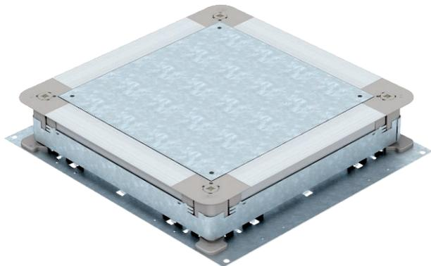
Unterflur Zug- und Abzweigdose für estrichüberdeckte Unterflur-Installationskanäle mit Seitenwänden aus Stahlblech. Zur Montage von Einbaueinheiten in Montagegedeckel (separat zu bestellen). Lässt sich stufenlos auf Estrichhöhe nivellieren (Schnellnivellierung möglich) und der Estrich kann bündig an die Estrichabzugskante angearbeitet werden. Mit schalltechnischer Entkopplungsmöglichkeit nach Estrichverlegung und mit Systemzubehör auch für Schwerlastanwendung verwendbar.
