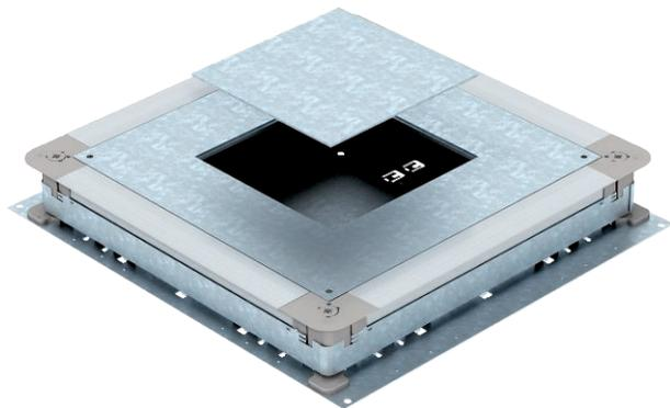
Unterflur-Gerätedose für estrichüberdeckte Unterflur-Installationskanäle mit Seitenwänden aus Stahlblech. Zur Montage von Einbaueinheiten der ausgewählten Nenngröße. Lässt sich stufenlos auf Estrichhöhe nivellieren (Schnellnivellierung möglich) und der Estrich kann bündig an die Estrichabzugskante angearbeitet werden. Mit schalltechnischer Entkopplungsmöglichkeit nach Estrichverlegung und mit Systemzubehör auch für Schwerlastanwendung verwendbar.
