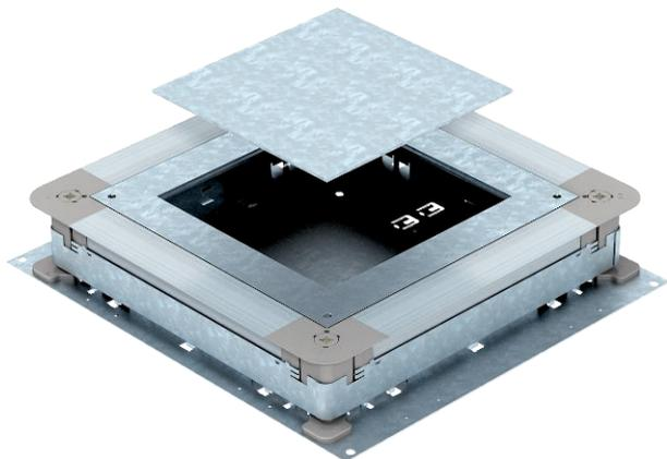
Unterflur-Gerätedose für estrichüberdeckte Unterflur-Installationskanäle mit Seitenwänden aus Stahlblech. Zur Montage von Einbaueinheiten der ausgewählten Nenngröße. Lässt sich stufenlos auf Estrichhöhe nivellieren (Schnellnivellierung möglich) und der Estrich kann bündig an die Estrichabzugskante angearbeitet werden. Mit schalltechnischer Entkopplungsmöglichkeit nach Estrichverlegung und mit Systemzubehör auch für Schwerlastanwendung verwendbar.
