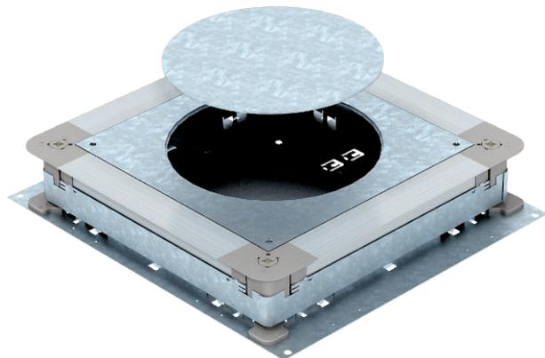
Unterflur-Gerätedose für estrichüberdeckte Unterflur-Installationskanäle mit Seitenwänden aus Stahlblech. Zur Montage von Einbaueinheiten der ausgewählten Nenngröße. Lässt sich stufenlos auf Estrichhöhe nivellieren (Schnellnivellierung möglich) und der Estrich kann bündig an die Estrichabzugskante angearbeitet werden. Mit schalltechnischer Entkopplungsmöglichkeit nach Estrichverlegung und mit Systemzubehör auch für Schwerlastanwendung verwendbar.
