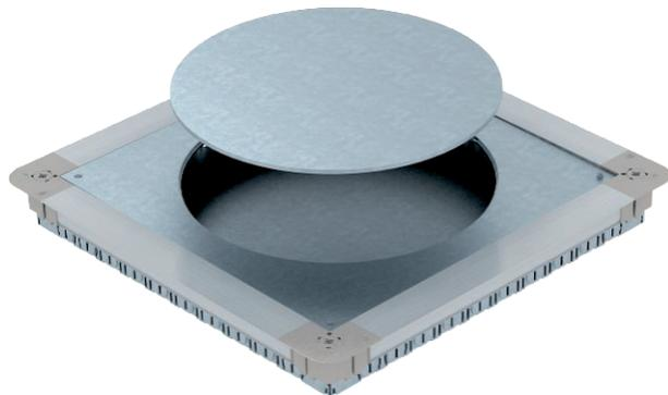
Unterflur-Gerätedose mit Montagedeckel und Deckelblindplatte mit Seitenwänden aus Stahlblech. Für den Einbau eines quadratischen Geräteeinsatzes GESR 55 in Estrichhöhen ab 55 mm. Lässt sich stufenlos auf Estrichnennhöhe nivellieren und der Estrich kann bündig an die Estrichabzugskante angearbeitet werden. Mit Rohreinführungsöffnungen je Seite 7 x M20, 3 x M25, 4 x M32. Nutzbare Rohrgröße bei einer Systemhöhe von 55 mm: M20.
