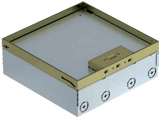
Quadratischer Bodentank für den Einsatz in trocken gepflegten Holzböden und Estrichböden im Innenbereich. Einbaugeschäube mit vorgeprägten Einführungsöffnungen für Rohre (M25). Oberseite durch 4 Nivellierstützen auf Oberkante Bodenbelag einstellbar. Die Mindesteinbautiefe beträgt 95 mm, der Nivellierbereich + 30 mm.
