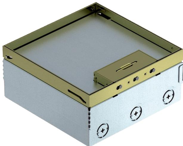
Quadratischer Bodentank für den Einsatz in trocken gepflegten Holzböden und Estrichböden im Innenbereich. Einbaugehäuse mit vorgeprägten Einführungsöffnungen für Rohre (M25). Oberteil durch 4 Nivellierstützen auf Oberkante Bodenbelag einstellbar. Die Mindesteinbautiefe beträgt 95 mm, der Nivellierbereich + 30 mm.
