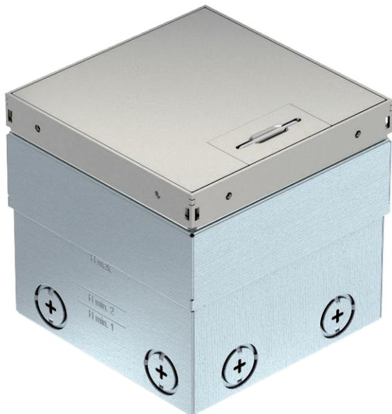
Quadratische Bodensteckdose für den Einsatz in trocken gepflegten Holzböden und Estrichböden im Innenbereich. Einbagehäuse mit vorgeprägten Einführungsöffnungen für Rohre (M20/M25). Oberteil durch 4 Nivellierstützen auf Oberkante Bodenbelag einstellbar. Die Mindesteinbautiefe beträgt 100 mm, der Nivellierbereich + 35 mm.
