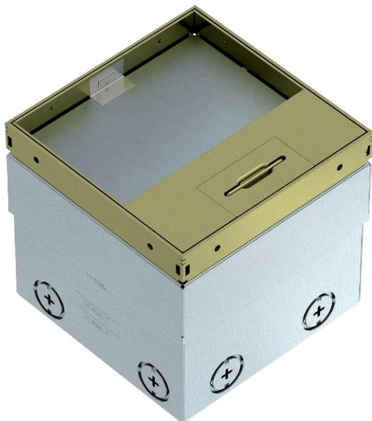
Quadratische Bodensteckdose für den Einsatz in trocken gepflegten Holzböden und Estrichböden im Innenbereich. Einbagehäuse mit vorgeprägten Einführungsöffnungen für Rohre (M20/M25). Oberteil durch 4 Nivellierstützen auf Oberkante Bodenbelag einstellbar. Die Mindesteinbautiefe beträgt 110 mm, der Nivellierbereich + 25 mm.
