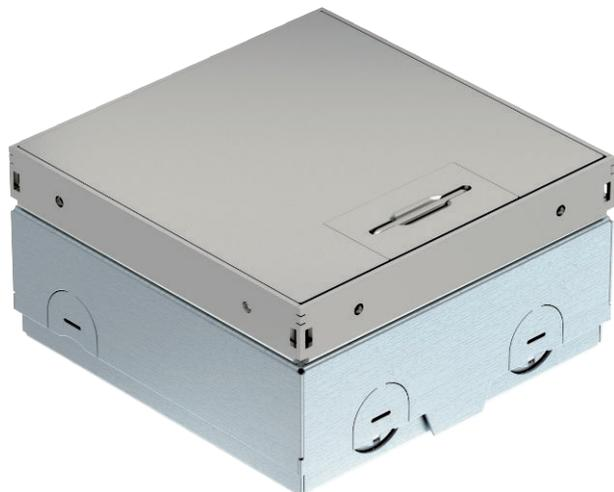
Quadratische Bodensteckdose für den Einsatz in trocken gepflegten System- und Estrichböden im Innenbereich. Einbaugehäuse mit vorgeprägten Einführungsöffnungen für Rohre (M20/M25). Oberteil durch 4 Nivellierstützen auf Oberkante Bodenbelag einstellbar. Die Mindesteinbautiefe beträgt 75 mm, der Nivellierbereich + 30 mm. Im Bodenbelag sichtbarer Rahmen und Deckel aus Edelstahl. Deckel mit Dekorplatte. Die Belastungsfähigkeit von 15 kN ist nur im nicht genutzten Zustand gewährleistet.
