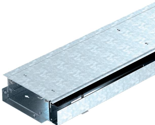
Montagefertige Kanaleinheit zur Leitungsführung und zum Geräteeinbau, bestehend aus einem Kanalunterteil mit zwei Deckeln, einer höhenverstellbarer Bürstenleiste und einem verstellbaren Bodenbelaganlegeprofil zur Estrichabgrenzung in Bereichen von Türleibungen und vor Heizkörpernischen. Im Lieferumfang enthalten sind zwei Deckelstoßdichtungen und ein Verbinder. Zur Höheneinstellung werden sechs Nivelliereinheiten benötigt.
