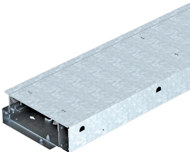
Montagefertige Kanaleinheit zur Leitungsführung und zum Geräteeinbau, bestehend aus einem Kanalunterteil mit zwei Blinddeckeln und zwei verstellbaren Bodenbelaganlegeprofilen zur Estrichabgrenzung in Bereichen von Türleibungen und vor Heizkörpernischen. Im Lieferumfang enthalten sind zwei Deckelstoßdichtungen und ein Verbinder.
