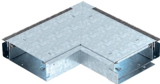
Montagefertiges Inneneck, bestehend aus Kanalunterteil, zwei Deckeln, höhenverstellbaren Seitenprofilen und wandseitig angeordneter Bürstenleiste zur Leitungsausführung. Im Lieferumfang enthalten sind eine Deckelstoßdichtung und ein Verbinder. Zur Höheneinstellung werden fünf Nivelliereinheiten benötigt.
