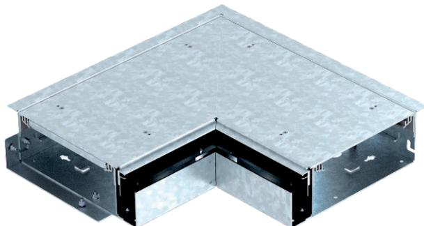
Montagefertiges Außeneck, bestehend aus Kanalunterteil, zwei Deckeln, höhenverstellbaren Seitenprofilen und wandseitig angeordneter Bürstenleiste zur Leitungsführung. Im Lieferumfang enthalten sind eine Deckelstoßdichtung und ein Verbinder. Zur Höheneinstellung werden vier Nivelliereinheiten benötigt.
