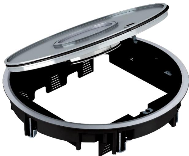
Geräteinsatz mit Tubus für nass gepflegte Böden für bis zu 12 Modul 45-Einzelgeräte in 3 Universalträger UT4, Einsatz in Kanalsystemen und Systemböden im Innenbereich. Oberfläche Aluminium glanzgedreht mit einer Bodenbelagsausparung von 3 mm. Für eine Einbautiefe von 65 mm.
