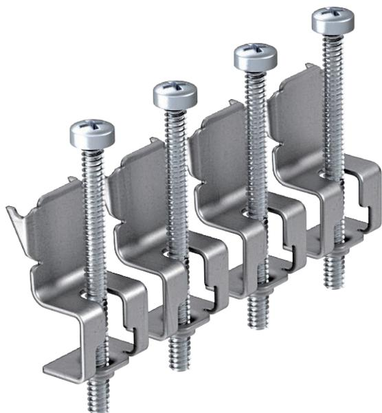
Vier Universalbefestigungen für runde Geräteeinsätze und Zugdoseneinsätze der Nenngrößen R4, R7 und R9 in Kanalsystemen, Doppel- und Hohlboden sowie für eckige Geräteeinsätze und Zugdoseneinsätze der Nenngrößen 4, 6 und 9 in Kanalsystemen. Zur Befestigung des Geräteeinsatzes GRAF9 werden acht Universalbefestigungen benötigt. Ersatzteil.
