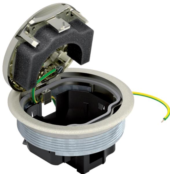
Runde Einbaueinheit mit Bodenbelagsschutzrahmen zum direkten Einbau in die Anschlussdose UDL2-120 im Innenbereich. Im geschlossenen Zustand kann die Einbaueinheit nass gepflegt werden. Die Mindesteinbautiefe beträgt 70 mm. Abdeckplatte und Steckdose der Serie Modul45 sind separat zu bestellen.
