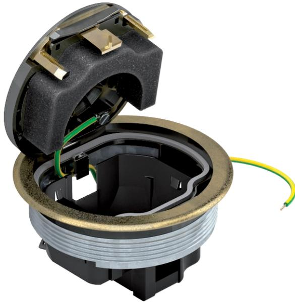
Runde Einbaueinheit mit Bodenbelagschutzrahmen zum direkten Einbau in die Anschlussdose UDL2-120. Im geschlossenen Zustand kann die Einbaueinheit nass gepflegt werden. Die Mindesteinbautiefe beträgt 70 mm. Abdeckplatte und Steckdose der Serie Modul45 sind separat zu bestellen.
