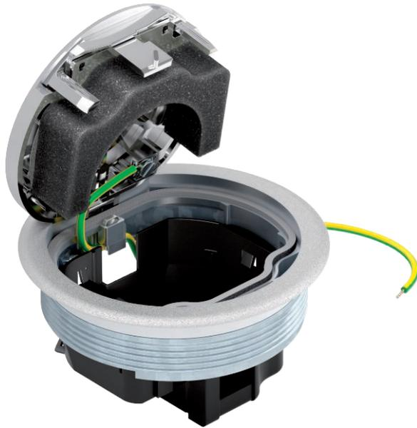
Runde Einbaueinheit mit Bodenbelagsschutzrahmen zum direkten Einbau in die Anschlussdose UDL2-120 im Innenbereich. Im geschlossenen Zustand kann die Einbaueinheit nass gepflegt werden. Die Mindesteinbautiefe beträgt 70 mm. Abdeckplatte und Steckdose der Serie Modul45 sind separat zu bestellen.
