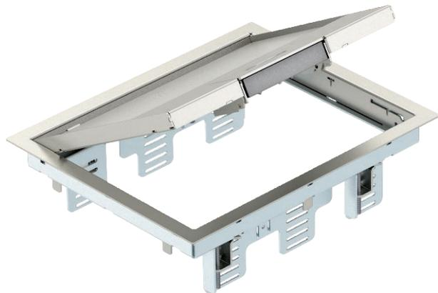
Geräteinsatz mit Griffbügel für bis zu 9 Modul 45-Einzelgeräte in 3 Universalträger UT3, Einsatz in Kanalsystemen und Systemböden im Innenbereich.
