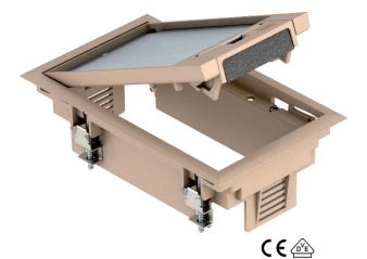
Geräteeinsatz mit Griffbügel für bis zu 3 Modul 45-Einzelgeräte in einem Universalträger UT3, Einsatz in Kanalsystemen im Innenbereich.
