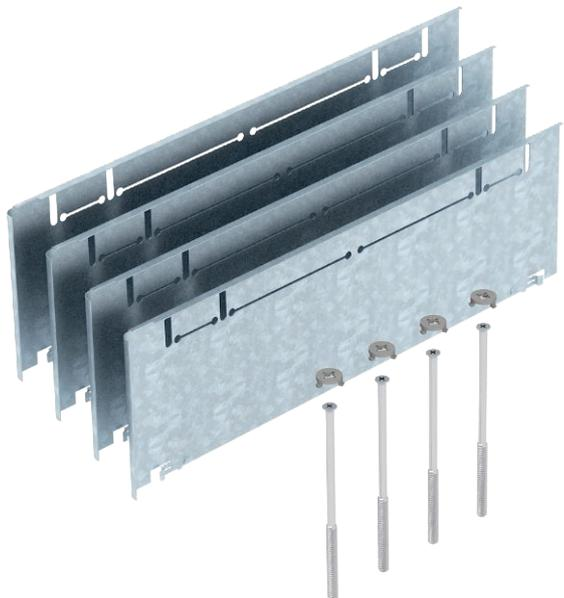
Höhenausgleich-Bausatz für Unterflurdosen UZD350-3 mit einer Bauhöhe von 115 bis 170 mm für die bauseitige Erhöhung der UZD, bestehend aus 4 Fallblechen, 4 Nivellierschrauben und 4 Drehverschlüssen.
