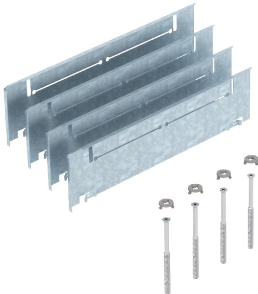
Höhenausgleich-Bausatz für Unterflurdosen UZD250-3 und UGD250-3 mit einer Bauhöhe von 70 bis 125 mm für die bauseitige Erhöhung der UZD/UGD, bestehend aus 4 Fallblechen, 4 Nivellierschrauben und 4 Drehverschlüssen.
