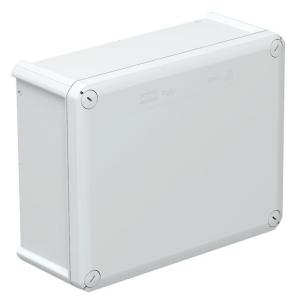
Kabelabzweigkasten zum Verbinden von Kabeln und Leitungen im Innenbereich und geschützten Außenbereichen. Rechteckige Form ohne Einführungen. Geeignet für die Wand-/ Deckenmontage, die Montage auf Montageblechen und Gewinde im Boden. Mit der Möglichkeit zur Innenbefestigung und Montage über die Eckdome. Deckel mit Schnellverschluss, plombierbar. Hergestellt aus halogenfreien und UV-resistenten Materialien.
