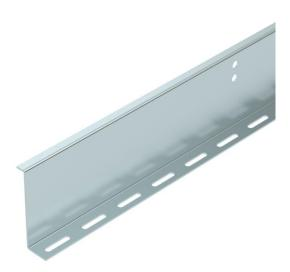
Trennsteg für das begehbare Kabelrinnen-System BKRS. Befestigung mit Flachrundschrauben M 6 x 12 mm in der Bodenlochung. Ab einer Breite von 200 mm sollte ein Trennsteg bei einer maximalen Fachgröße
