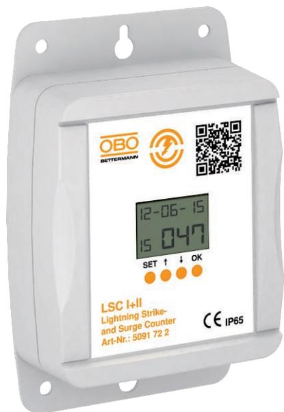
Der Blitzstromzähler LSC I+II erfasst Impulsströme und speichert diese samt Uhrzeit und Datum fest ab. Somit findet eine ständige Kontrolle statt, ob ein Blitz in das Blitzschutzsystem eingeschlagen hat. Sollte dies der Fall sein, so muss nach VDE 0185-305 (IEC 62305) das Blitzschutzsystem gewartet werden.
