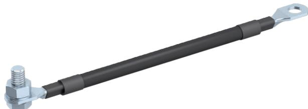
UV-beständige Anschlussleitung (Kupfer 25 mm<sup>2</sup>) zur Montage der OBO EX-Trennfunkstrecke Typ EX ISG an Isolierflanschen und Isolierstücken. Beidseitig mit Kabelschuh für M10 Schrauben, einseitig mit M10 Schraube, Mutter und Federring.
