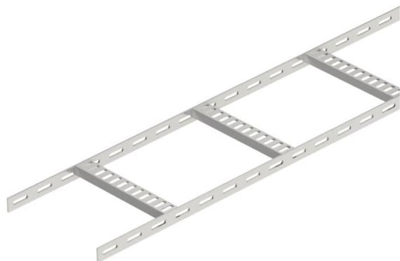
Schiffsbau-Kabelleiter mit gelochtem Seitenholm in der Seitenhöhe 25 mm, mit eingeschweißten, nach unten offenen und gelochten Trapezsprossen. Belastung geprüft nach IEC in Kombination mit Verbinder Typ SLV.
