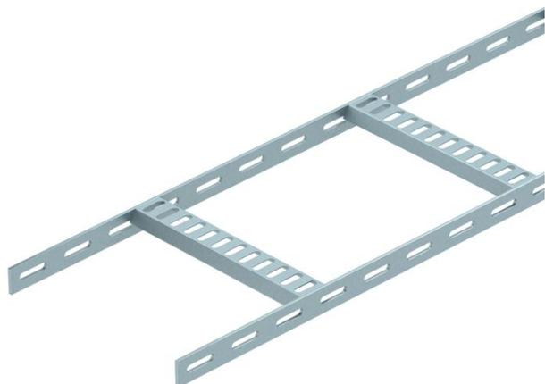
Schiffsbau-Kabelleiter mit gelochtem Seitenholm in der Seitenhöhe 25 mm, mit eingeschweißten, nach unten offenen und gelochten Trapezsprossen. Belastung geprüft nach IEC in Kombination mit Verbinder Typ SLV.
