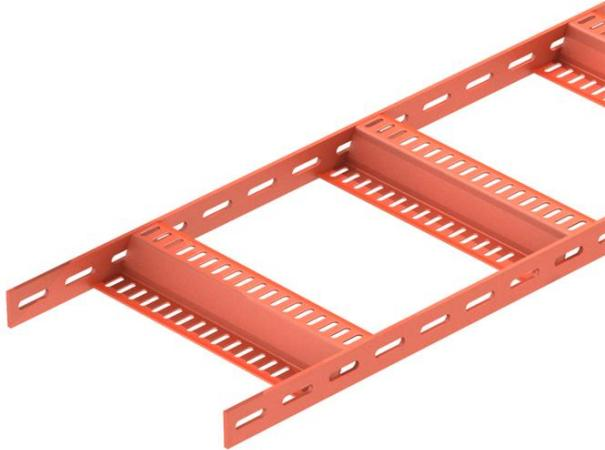
Schiffskabelleiter mit gelochtem Seitenholm in der Seitenhöhe 40 mm mit eingeschweißten, gelochten Z-Sprossen. Belastung geprüft nach IEC in Kombination mit Verbinder Typ SLV. Schweißgrundierung Typ SIGMA-WELD 199, auch in weiß erhältlich.
