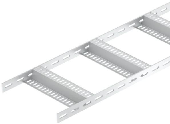
Schiffsbau-Kabelleiter mit gelochtem Seitenholm in der Seitenhöhe 40 mm mit eingeschweißten, gelochten Z-Sprossen.
