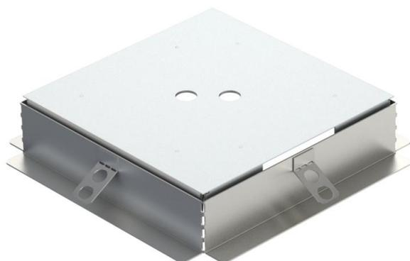
Überschleifbarer Schalkörper zum direkten und fugenlosen Einbau von nivellierbaren Kassetten, Nenngröße 9, in oberflächenfertige Estriche/Terrazzo-Böden. Die Schalung wird schwimmend auf Unterflurdosen mit Montagedeckel Nenngröße 9 aufgelegt und schließt die Freiräume zwischen Unterflurdose und Kassettenrahmen.
