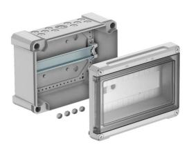
Kleinverteiler zur Aufputz-Montage, für die Strom-Unterverteilung im Innen- und geschützten Außenbereich, gemäß IEC 439-3. Mit vormontierter 35-mm-Hutprofilschiene. Schutzart IP66 und Schutzgrad IK06. Transparenter Deckel zum Schrauben, mit Ausschnitt.
